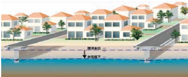
図-4 液状化対策工法（地下水位低下工法）
