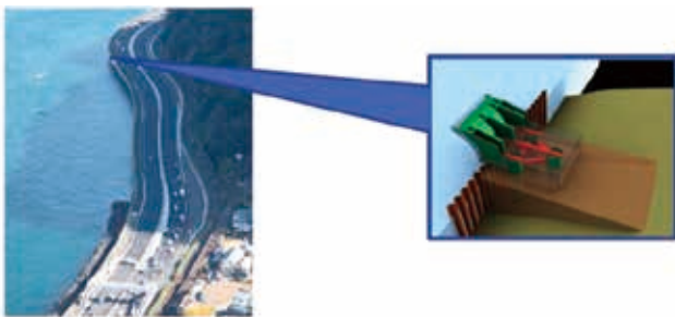
図-5 護岸と抑止杭による海岸道路の拡幅事業
