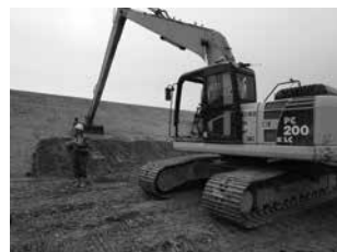
MGバックホウと追尾型トータルステーション
