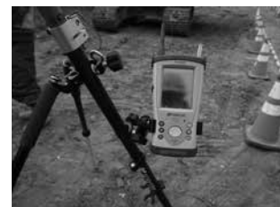
MGバックホウと追尾型トータルステーション
