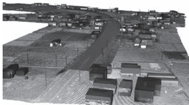
図2 点群データ+3D都市モデル+3次元設計データの合成
