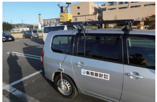
写真2 車載写真レーザ測量の作業状況
