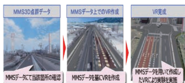
図-2 MMS点群データを用いたVRの構築
