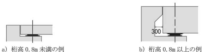
図 2-95 PC プレテンション桁の例
