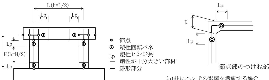
図6-68 塑性ヒンジ長  $L_p (=0.2h-0.1D)$  における  $h$  と  $D$  のとり方
