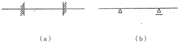
図4-97 床版の死荷重による曲げモーメントを算出するための解析モデル
