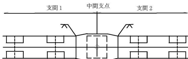
図4-27 連続桁の中間支点の一部を拡幅する場合の下フランジ幅
