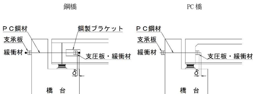
a) 橋台と上部構造を連結する落橋防止構造
