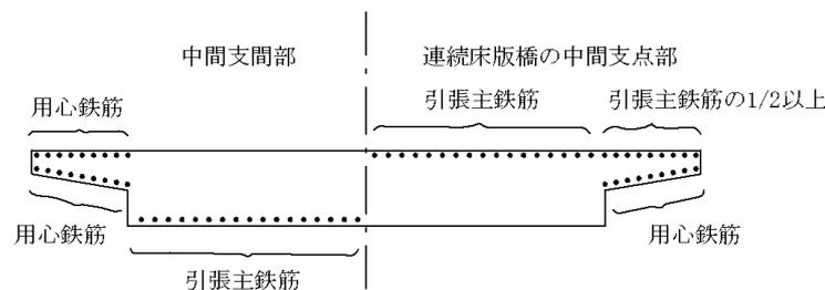
図5-87 片持床版の用心鉄筋
