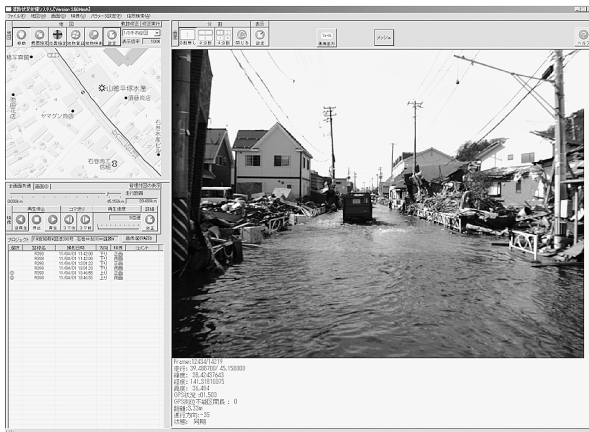
簡理くんが撮影した正面の画像と場所を表す地図。カメラを増設すれば左右の画像も撮れてパノラマになる
