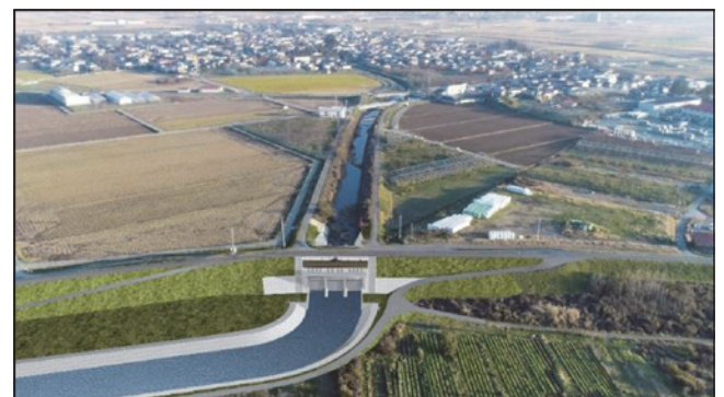
図3 UAV写真と三次元モデルの合成
