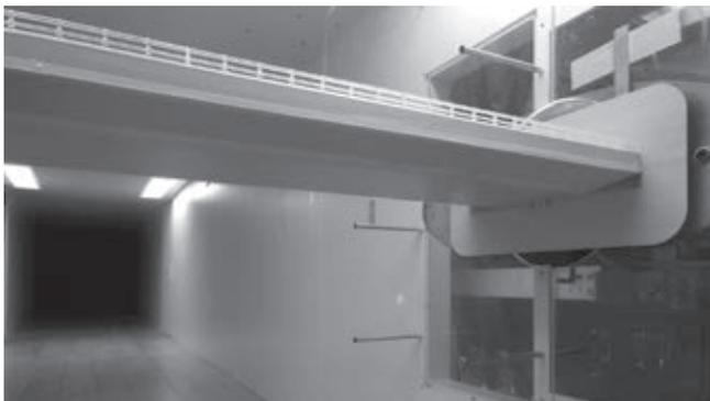
写真2 主桁風洞試験模型
